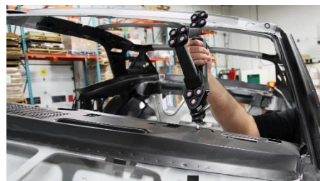
プローブによる基準穴の精密測定
