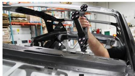
プローブによる基準穴の精密測定
