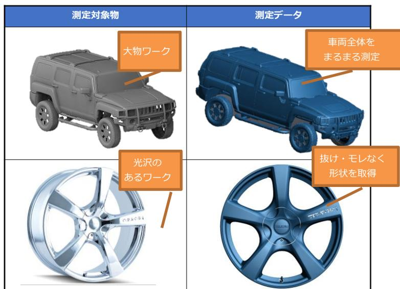
接触式と非接触式のハイブリッド測定
