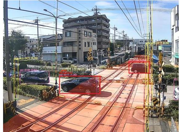
現行における踏切内の異常を検知する装置は、「踏切内に物体が存在しているかどうか」を検知しています。踏切が動作して遮断桿が下りている間で踏切内に物体を検知すると、踏切周辺の信号機が自動的に反応して、付近を走行中の列車に異常を知らせています。
