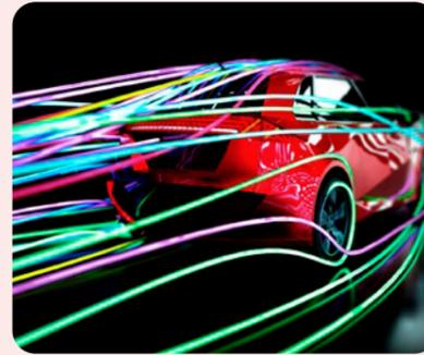
車両開発の過程でおこなわれる、大規模なCAEによる空力・衝突・耐久性などの性能解析。不可欠な工程ですが、スーパーコンピューターでも丸1日必要です。今回、トヨタ自動車の蓄積された数多くのデータから、機械学習により30秒以下のごく短時間で空力を予測できる技術を開発。機械学習に向かない三次元形状を独自の形式で縮退することによって処理をおこない、特定の条件下であれば実用可能な精度での予測を実現しました。CAEの事前検証として使用することで、設計・計算・分析のサイクルを大幅に短縮することが可能です。CADデータなどを入力するだけなので、デザインや企画の段階で利用することにより、手戻りを減らすことができます。同じ仕組みで流体の予測もできますが、ほかの現象にも横展開できるようにさらなる技術向上を進めています。
